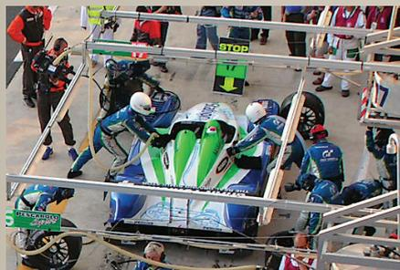
Les systèmes de remplissage rapide sont des éléments incontournables des opérations de ravitaillement. Ces systèmes de «refueling» sont homologués FIA et vous assurent le remplissage rapide en toute sécurité.
