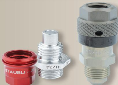
Stäubli a adapté le célèbre coupleur SPH03 à la purge des frein. Avec l'about installé sur l'étrier à la place du purgeur, le dispositif est toujours prêt à être purgé rapidement. La technologie «sans fuite» du SPH03 est tout a fait adaptée à ce système qui permet une purge des frein non seulement rapide, mais sans risque d'entées d'air dans le circuit à la déconnexion ou de fuite de liquide de frein à la purge. Un capuchon en alu protège l'about-purgeur quand il n'est pas couplé au connecteur.
