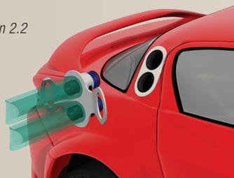
Il faudra choisir une poignée à montage «2.2» : les vannes mâles et la poignée sont sur deux axes différents, perpendiculaires l'un à l'autre. C'est aussi le montage que l'on choisira en moto si les vannes femelles sont installées transversalement.
