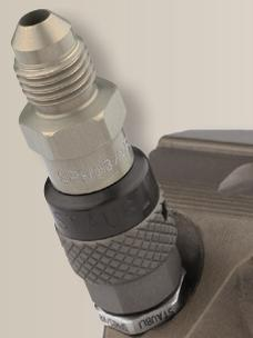
Connecteur couplé sur l'about en place sur l'étrier, à la place du purgeur d'origine.
