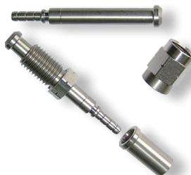
Ces raccords sont composés d'une bague écrou et d'un nipple (ou insert) sertis avec une fêrule. Ils sont donc tournants et le nipple possède un double siège (convexe et concave)
