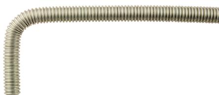
Il s'agit d'un tuyau inox convoluto, extrêmement léger et très facile à mettre en forme. Idéal pour les systèmes de mise à l'air, conduits de retour, aspiration et systèmes basse pression. Il permet en outre une excellente dissipation des calories. Ce tuyau étant annelé et non en spirale, il peut être manchonné sans risque de fuite.
